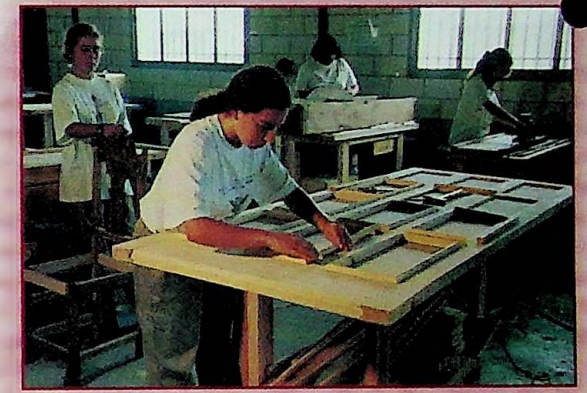
Construcción de una puerta perforada de pino flandes y barnizada al natural
